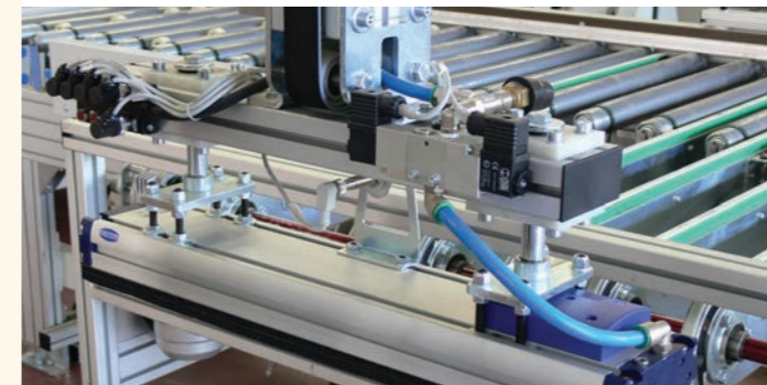
1 Gruppo di presa a cuscini a depressione. Vacuum pad gripping unit.
